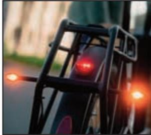
Mit Turntec lassen sich Richtungswechsel ganz einfach per Fingerdruck anzeigen
